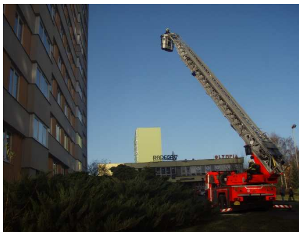
Obrázek 3 K záchraně osob z vyšších pater budovy slouží požární žebříky a plošiny
